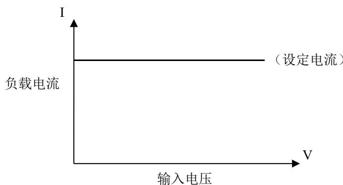
按【定电流】键进入定电流模式，该按键灯亮起，通过数字按键输入需要设定的电流值，输入的数字会在状态栏 **Is = 0.0000A** 显示，输入完成后按【Ent】键确认。按【启动】键或【ON】键启动负载测量。
