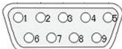
1. **①** 6 脚、7 脚用作远端输入。6 脚为电压正端，7 脚为负端，请勿反接！
