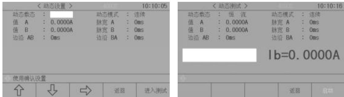
动态测试可使负载在两种电压或电流间反复切换，此功能可用来测试电源的动态特性。
