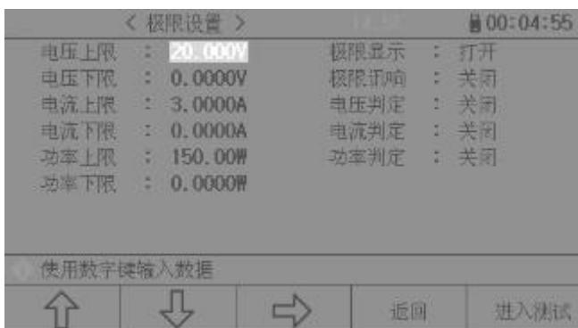
该页面下可以设置电压，电流，功率判断参数，并在主测试界面显示区域内显示判断结果，超过设置值的会以红色反显提示。
