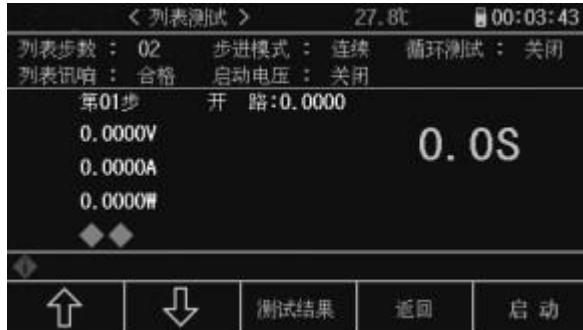
■ 提示： 进入测试页面启动测量， 页面显示当前测试步的测量及判断结果。
