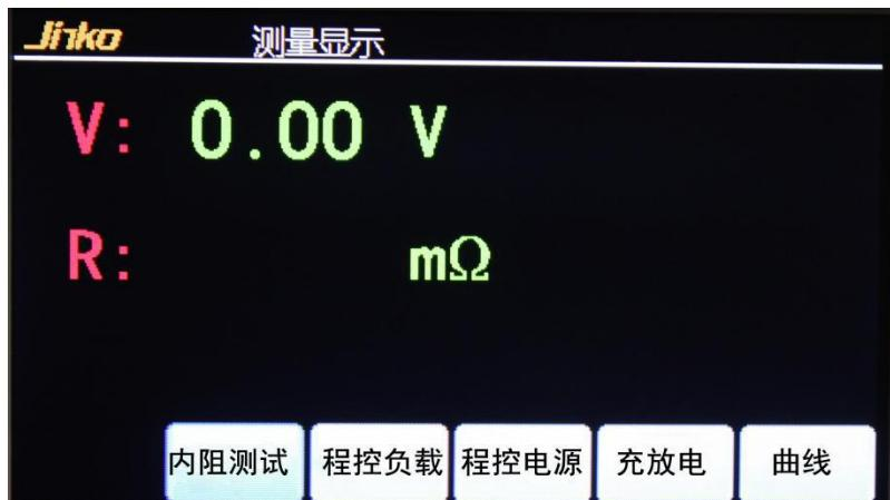
系统默认过流测试关闭, 开机时主功能界面是不显示过流测试参数的, 如需打开过流测试功能, 按“SETUP”键进入设置界面, 按上下键选择功能, 光标移动到过流测试, 按“确认▼”键打开过流测试功能,
