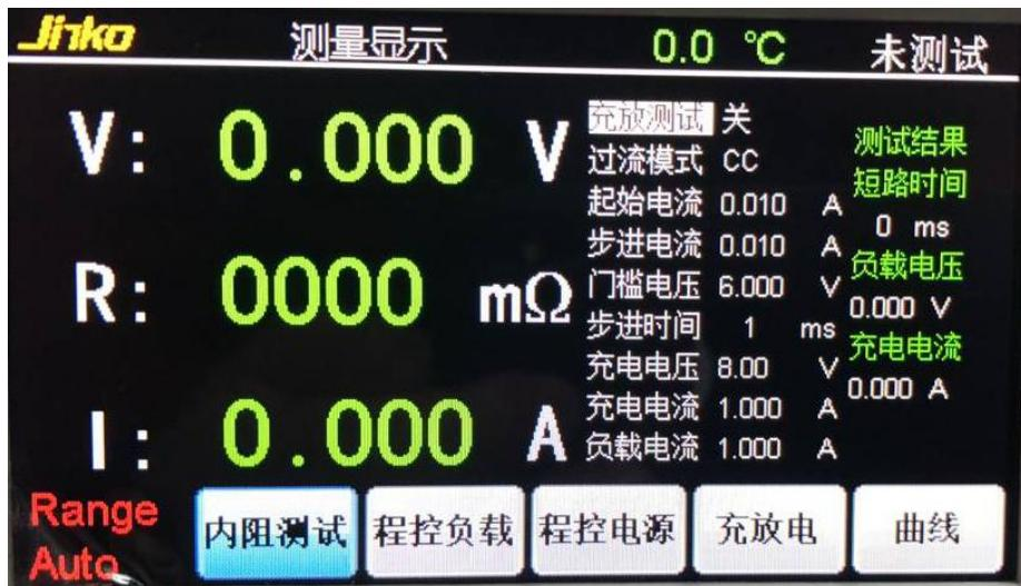
1. 内阻测试界面左下角显示的是当前内阻测试的档位状态，若显示为 AUTO，则档位自动切换；若显示为  $250\text{m}\Omega$ ，则说明当前测量的内阻范围为  $0\text{-}250\text{m}\Omega$ 。若显示为  $2000\text{m}\Omega$ ，则说明当前测量的内阻范围为  $0\text{-}2000\text{m}\Omega$ 。三种状态通过档位键切换点来设置（此功能仅 JK5530B 有）
