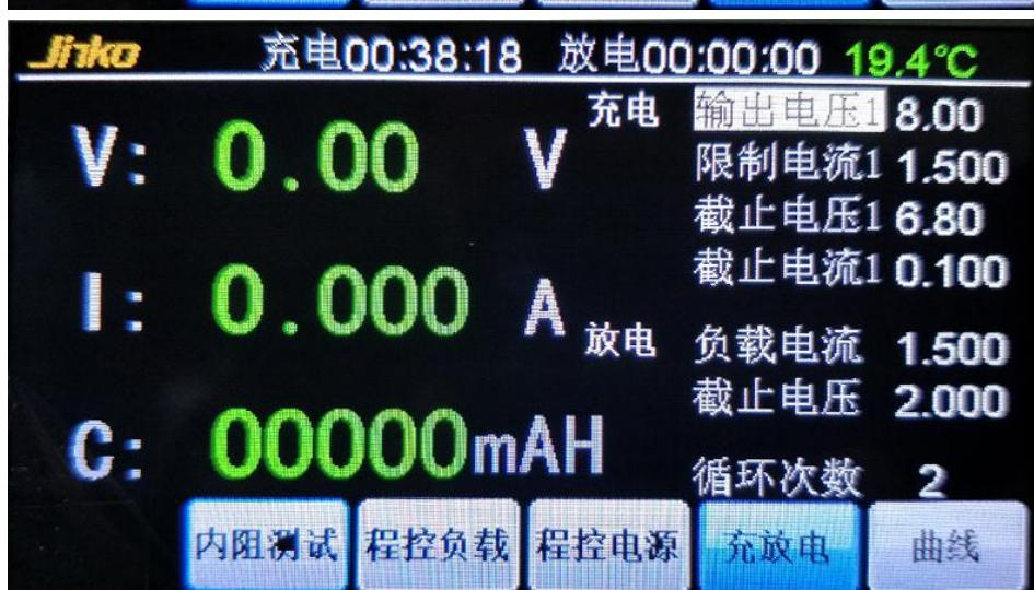
如果需要分步充电，建议用户第一步用大电流，第二步用小电流，第三步用涓流。
