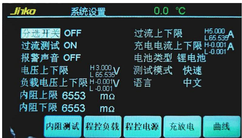
设置完成后，按“内阻测试”按键，返回到内阻测试界面，则会出现过流测试参数，如图所示：
