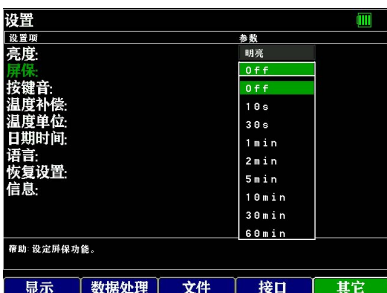
选择记录仪屏保时间，达到定时后，记录仪会熄屏，但不会停止数据采集和记录等功能。
