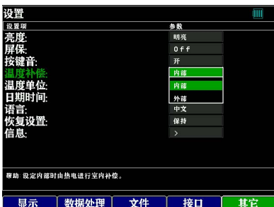
记录仪环境温度补偿方式，内部补偿使用记录仪内部测温探头进行环境温度补偿；外部补偿时请使用第一通道，接上K型热电偶，记录仪会用第一通道测得的温度数据来进行环境温度补偿。
