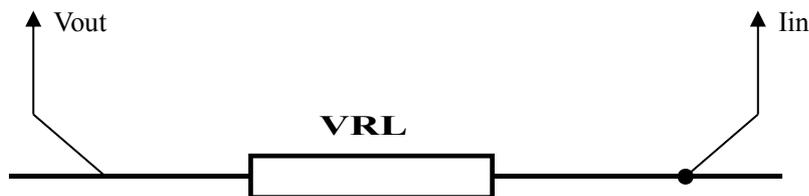
图 8：正确的测试端口与负载连接示意图
