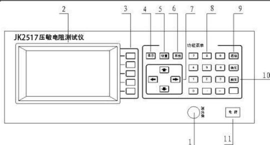
图 1： 2517 压敏电阻测试仪面板示意图
